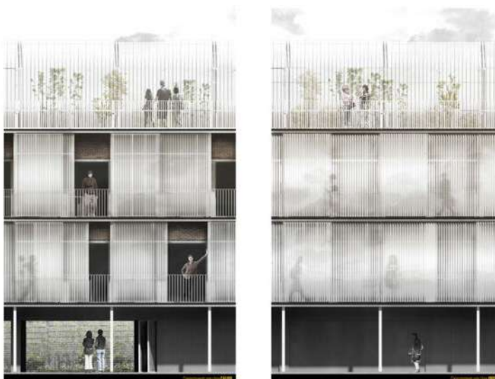
Piel variable en función de las condiciones climáticas | Variable skin in accordance with the weather conditions
